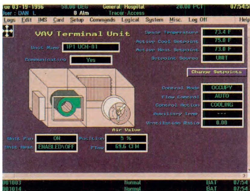
Σχήμα 10-20. Ο έλεγχος των στοιχείων τερματικής μονάδας κλιματισμού, όπως εμφανίζεται στην οθόνη του Η/Υ σε κεντρικό σύστημα διαχείρισης κτιρίων (B.M.S.).
