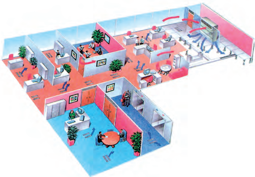
Σχήμα 8-67: Κλιματισμός συγκροτήματος γραφείων με μονάδα κλειστού κυκλώματος.
