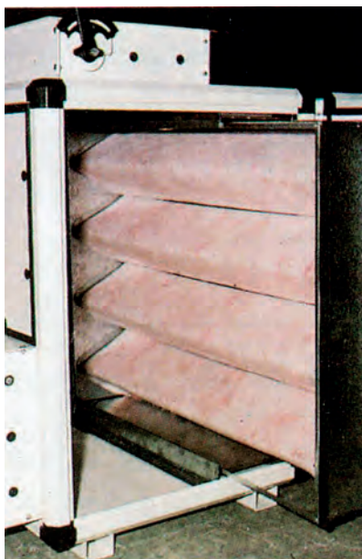
Σχήμα 8-45: Φίλτρο ΚΚΜ, με επιτρεπόμενη ταχύτητα αέρα 1,5 m/s και μετωπική στο στοιχείο 2,5 m/s. Με τη μορφή αυτή αυξάνεται η συνολική επιφάνεια του φίλτρου, οπότε μειώνεται και η κάθετη συνιστώσα της ταχύτητας πάνω στο φίλτρο.
