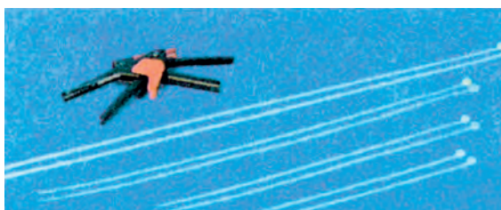
Εικόνα 11.6: Πλαστικοί σφιγκτήρες διαφόρων μεγεθών και εργαλείο σύσφιξης
