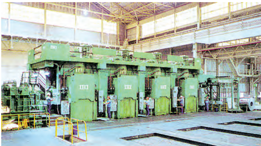
Σχήμα 13.13: Τετραπλό έλαστρο ψυχρής έλασης (Hellenic Steel)
