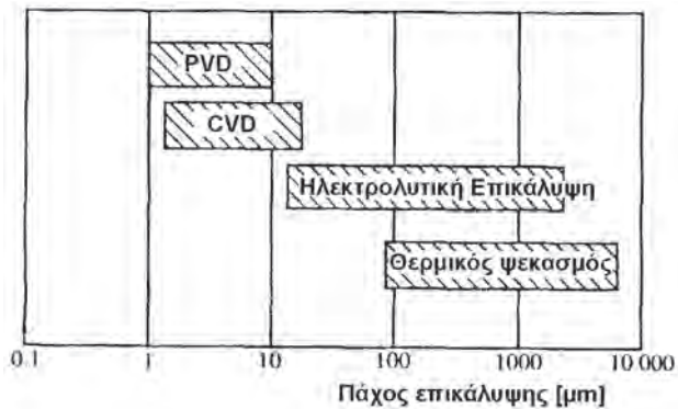
Σχήμα 17.7: Μεταβολή του πάχους επικάλυψης για διάφορες κατεργασίες με απόθεση υλικού
