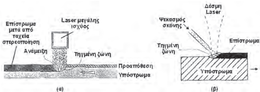
Σχήμα 18.9: Τεχνικές επικάλυψης με δέσμη laser: (α) με προαπόθεση σκόνης και (β) με ταυτόχρονο ψεκασμό σκόνης
