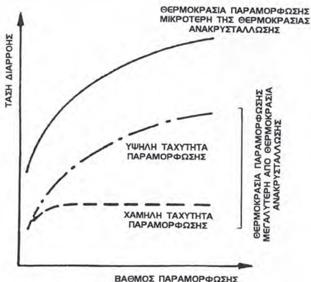
Σχήμα 12.5: Επίδραση της ταχύτητας παραμόρφωσης στο όριο διαρροής
