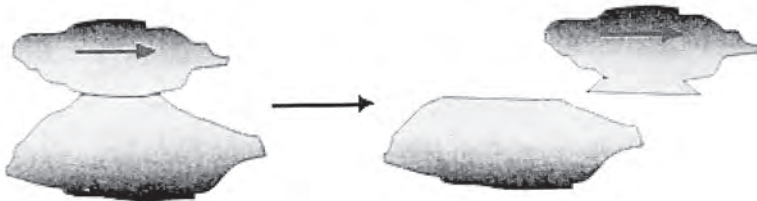
Σχήμα 17.1: Σχηματική παράσταση της φθοράς πρόσφυσης
