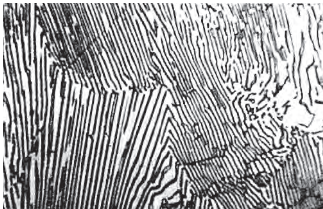
Σχήμα 4.4: Μορφή φυλλοειδούς ευτηκτικού (μεγέθυνση X2000)
