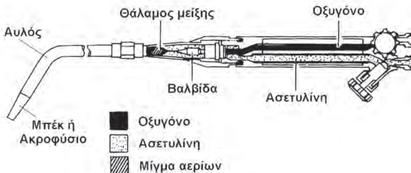
Σχήμα 16.5: Καυστήρας οξυγονοκόλλησης
