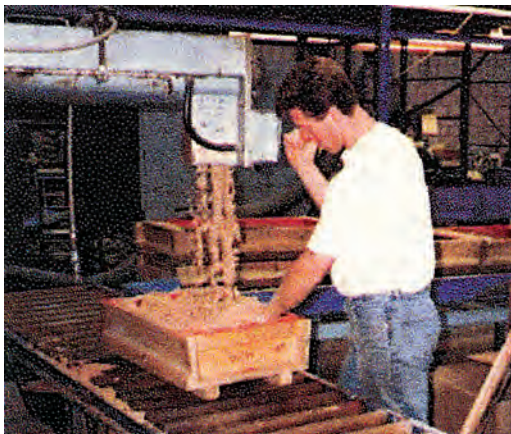
Σχήμα 10.6: Μηχανική τροφοδοσία άμμου σε καλούπι
