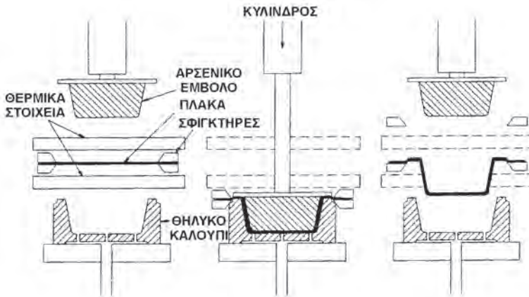
Σχήμα 15.17: Θερμοδιαμόρφωση
