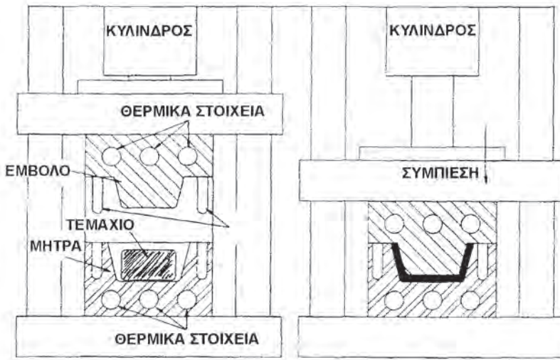
Σχήμα 15.11: Χύτευση με συμπίεση
