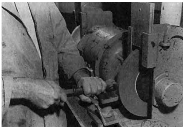
Σχήμα 6.9: Ανανέωση τροχού με αυλακοειδή χαλύβδινο τροχό.
