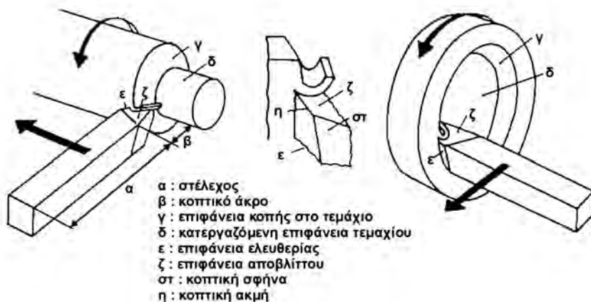
Σχήμα 4.21: Χαρακτηριστικές επιφάνειες και ακμές του εργαλείου και του κατεργαζόμενου τεμαχίου κατά την τórνευση.
