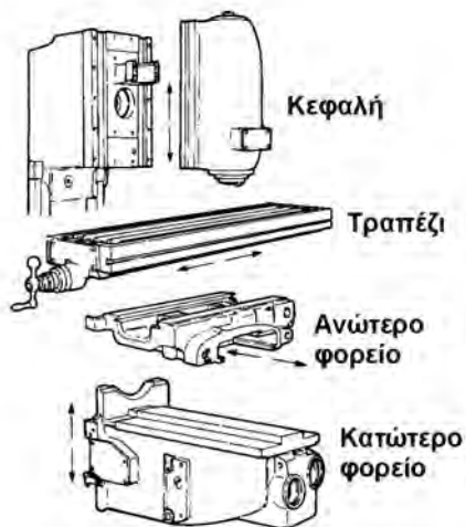
Σχήμα 5.11: Κύρια μέρη μίας κατακόρυφης φρεζομηχανής.
