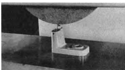
Σχήμα 6.10: Ανανέωση τροχού με εργαλεία από διαμάντι (Α) το εργαλείο εδράζεται σε μία απλή μηχανή συγκράτησης, (Β) υπερκείμενη μηχανή ανανέωσης, όπου το βαθμονομημένο μικρόμετρο ελέγχει την καθοδική πρόωση του διαμαντιού και ο μοχλός μετακινεί εγκάρσια (μπροστά-πίσω) το διαμάντι.
