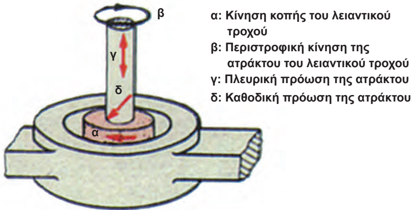
Σχήμα 6.19: Κινηματική της λείανσης με πλανητική άτρακτο.
