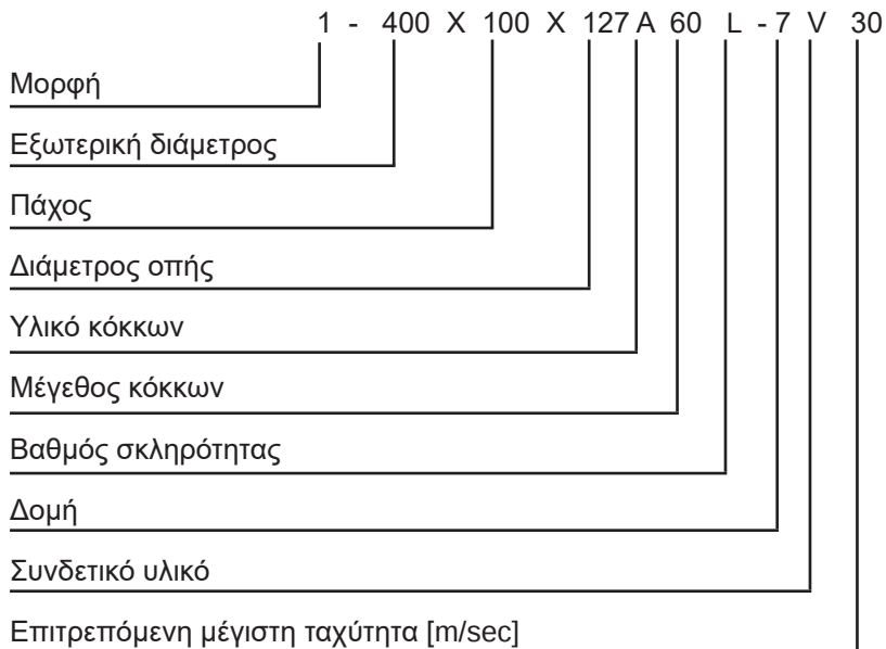
Σχήμα 6.6: Κωδική ονομασία λειαντικών τροχών.
