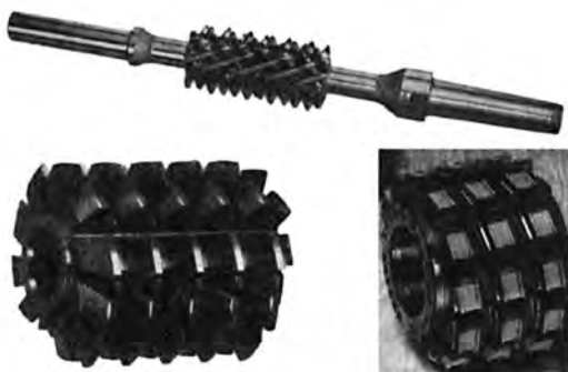
Σχήμα 5.46: Κοχλιοειδείς φρέζες (χομπ).
