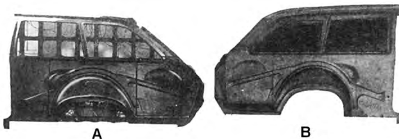
Σχήμα 9.11: Κατασκευή εργαλείου πρέσας με ηλεκτροδιάβρωση (A) και το αντίστοιχο εργαλείο-ηλεκτρόδιο της κατεργασίας (B).
