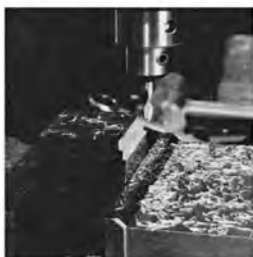
Φρεζάρισμα περιφέρειας κομματιού με κονδύλι
