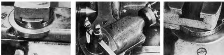
Σχήμα 4.39: Τόρνευση κωνικής επιφάνειας με στροφή του εργαλειοδέτη.
