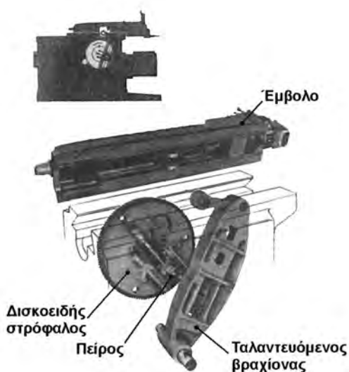
Σχήμα 7.8: Μηχανισμός παλινδρομικής κίνησης του εμβόλου.
