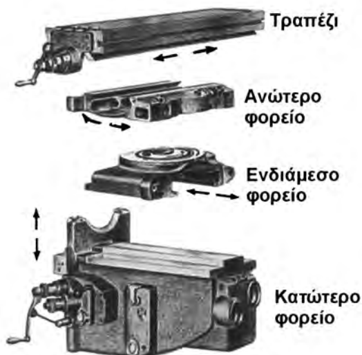
Σχήμα 5.10: Συγκρότημα τραπεζιού οριζόντιας φρεζομηχανής γενικής χρήσης (universal).
