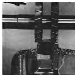
Φρεζάρισμα με δύο τρίκοπες φρέζες
