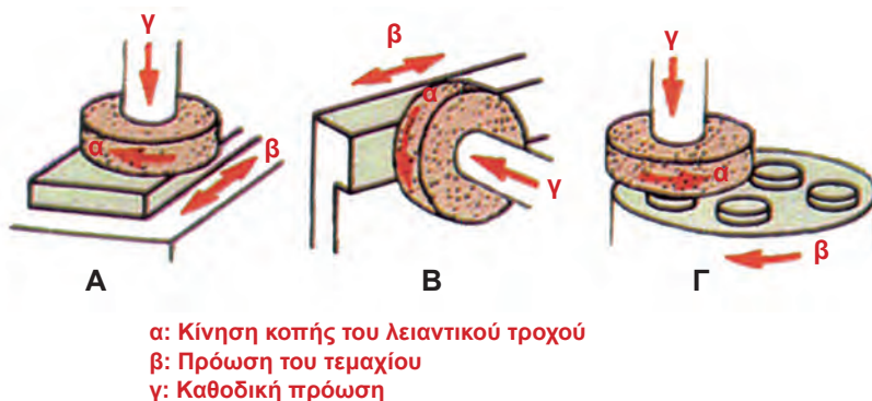
Σχήμα 6.21: Μετωπική λείανση (Α) με κάθετη άτρακτο και διαμήκη τράπεζα, (Β) με οριζόντια άτρακτο και διαμήκη τράπεζα και (Γ) με κάθετη άτρακτο και κυκλική τράπεζα.
