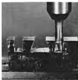
Φρεζάρισμα αυλακιού "Τ" με εργαλείο μορφής
