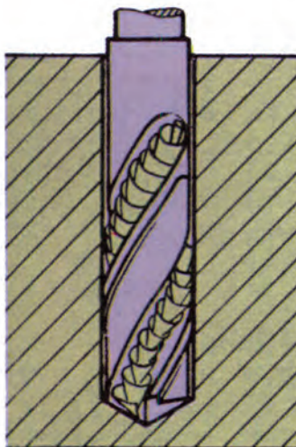
Σχήμα 8.26: Συνεχής απομάκρυνση των γρεζιών από μεγάλου βάθους οπή.
