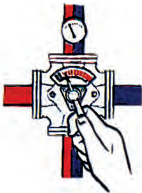
Εικ. (8.35) Ρύθμιση Τετράοδης βάνας αναμείξεως.
