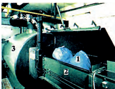
ΣΧ. 4.4ζ Καύση σκουπιδιών. Διακρίνονται οι σακούλες με τα απορρίμματα (1), ο μηχανισμός αυτόματης τροφοδότησης (2) και ο λέβητας (3).
