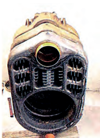
ΣΧ. 4.3α Συναρμολόγηση στοιχείων μαντεμένιου λέβητα.
