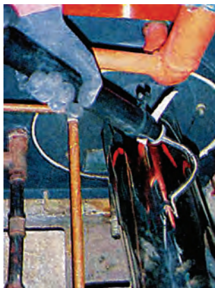
ΣΧ.9.41 Μέτρηση αιθάλης.
