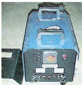
ΣΧ. 1.9κθ Ηλεκτροκόλληση.
