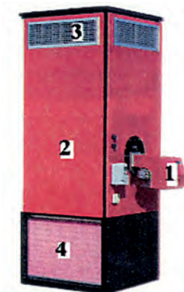
ΣΧ. 4.4θ Αερολέβητας. Βασικά στοιχεία του ο καυστήρας (1), ο λέβητας (2), το σύστημα εξαγωγής ζεστού αέρα (3) και η εισαγωγή του ανακυκλοφορούντος αέρα (4). Πρόκειται για αξιόπιστη λύση, που αντιμετωπίζει έκτακτες ανάγκες και παρουσιάζει ιδιαίτερη ευκολία στη μεταφορά της από σημείο σε σημείο.
