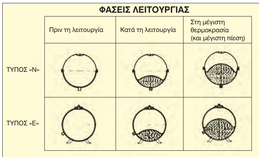
Σχήμα 3.27: Φάσεις λειτουργίας κλειστού δοχείου διαστολής με μεμβράνη
