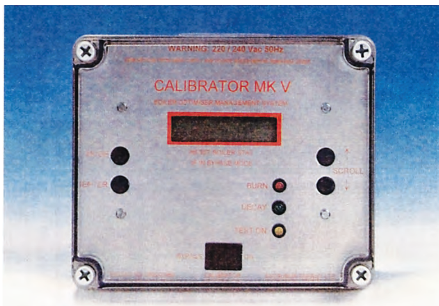
Εικόνα 5.4.: Ηλεκτρονική συσκευή συστήματος ελέγχου και διαχείρισης εγκατάστασης Κ.Θ.
