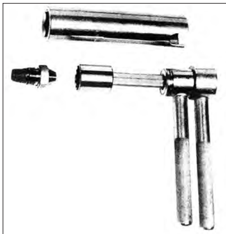
Εικόνα 2.3: Καλύμπρα για τοποθέτηση και ρύθμιση δίσκου διασκορπισμού.
