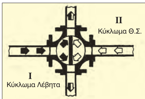
Σχήμα 3.7: Βάνα με πεταλούδα σε ενδιάμεση θέση
