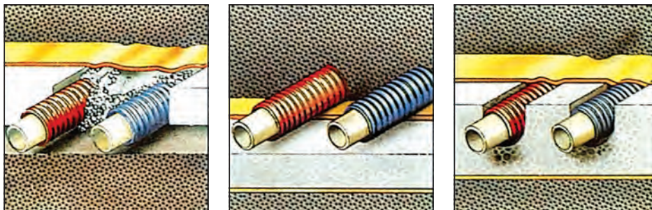
Σχήμα 4.21: Πλαστικός κυματοειδής σωλήνας προστασίας
