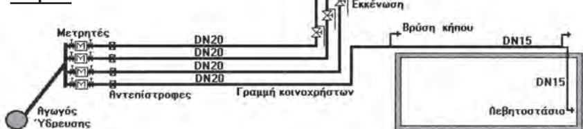
ΣΧ. 2.13.1.α Κατακόρυφο δίκτυο κρύου-ζεστού νερού με διακλαδώσεις. Κάθε ιδιοκτησία έχει τη δική της παροχή, με ελάχιστη διάμετρο σωλήνα DN20 (3/4").
