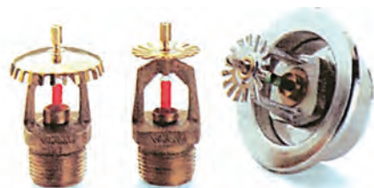
ΣΧ. 10.2.3.α Διάφοροι τύποι καταιονητήρων. Διακρίνονται οι κόκκινοι βολβοί και τα πτερύγια διασκορπισμού του νερού.
