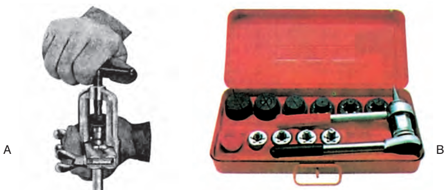
Σχ. 3-5.4ε. (Α). Εκτόνωση με πλάκα και καβαλέτο. (Β). Σετ εκτονωτικών εργαλείων για υδραυλικούς, σε μεταλλική θήκη.
