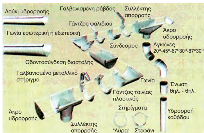
Σχ. 8-2.2γ. Εξαρτήματα για την κατασκευή υδρορροής σε στέγη.
