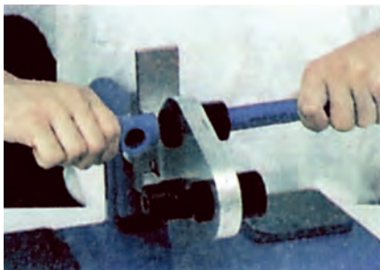
Σχ. 4-2.4β. Η ταυτόχρονη θέρμανση του εξαρτήματος και του σωλήνα για να συγκολληθούν.
