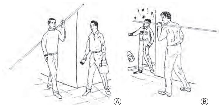
Σχ. 1-1.2δ. (Α) Καλός και (Β) κακός τρόπος μετακίνησης σωλήνων.
