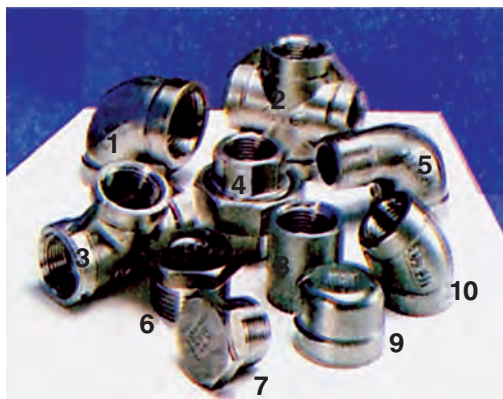
Σχ. 2-6.2α. Εξαρτήματα χαλυβδοσωλήνων (ή σίδηροσωλήνων) 1. Γωνιά, 2. Σταυρός, 3. Ταυ, 4. Ρακόρ, 5. Γωνιά αρσενική-θηλυκή, 6. Συστολή Αμερικής, 7. Τάπα αρσενική, 8. Μούφα, 9. Τάπα θηλυκή, 10. Καμπύλη.
