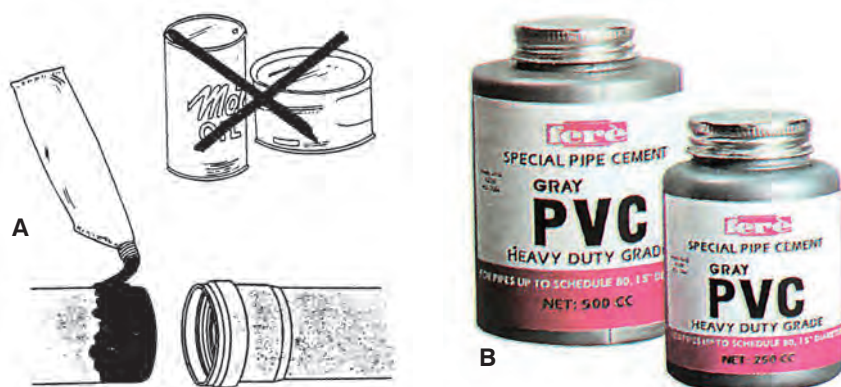
Σχ. 6-1.4γ. (Α). Η επάλειψη των σωλήνων με ειδική κόλλα. (Β). Συνήθης συσκευασία κόλλας για PVC.
