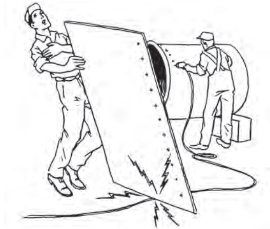
Σχ. 1-2.2στ. Προσοχή στα καλώδια τροφοδότησης ηλεκτρικών εργαλείων. Ο κίνδυνος ηλεκτροπληξίας είναι μεγάλος.
