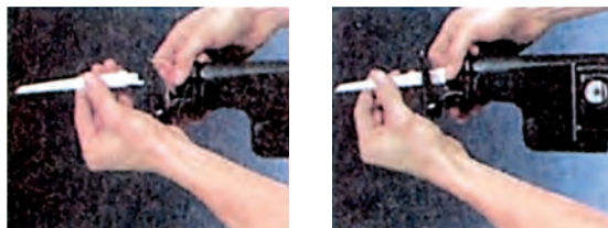
Σχ. 2 - 1.4ζ. Τοποθέτηση της λάμας στο ηλεκτρικό πριόνι.
