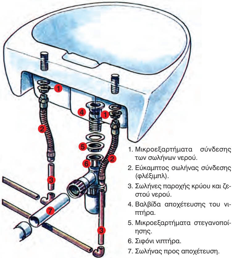
Σχ. 7-2.4β. Γενική άποψη των εξαρτημάτων σύνδεσης του νιπτήρα.
