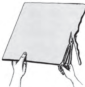
Σχ. 5-1.4δ. Η κοπή των περιττών τεμαχίων για το γώνιασμα του μολυβδόφυλλου
