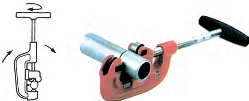
Σχ. 2 - 1.4δ. Διαδικασία κοπής σωλήνα με σωληνοκόφτη.
