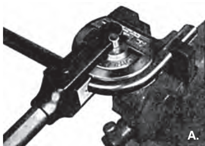
Σχ. 2 - 3.2α. (Α). Χειροκίνητος κουρμπαδόρος. (Β). Υδραυλικός κουρμπαδόρος.
