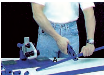
Σχ. 4-2.4α. (Α). Το κόψιμο των απαραίτητων τεμαχίων σωλήνα (PP). (Β). Δοκιμαστική συναρμολόγηση στον πάγκο.
