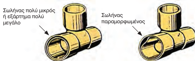
Σχ. 3-6.2α. Ελαττώματα που πρέπει να αποφεύγουμε κατά την τριχοειδή συγκόλληση.
