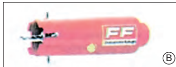
Σχ. 1-2.4β. (Α). Τρυπάνι οδηγός (διαμαντοτρύπανο) (Β). Κοπτικό εργαλείο (ποτηράκι).
