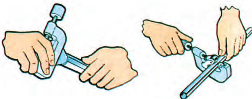
Εικόνα 8 Κοπή σωλήνα από χαλκό.
