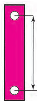
Εικόνα 9.3.1α Απόσταση από ρακόρ σε ρακόρ.
