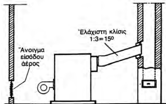
Εικόνα 7.8.1 Σχήμα σύνδεσης λέβητα με την καπνοδόχο.
