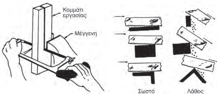
Σχήμα 4.9ε Σωστή χρήση του πριονιού
