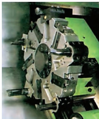
Σχήμα 1.3β Σύγχρονος προγραμματιζόμενος τóρνος (CNC) και η εργαλειοφόρα κεφαλή του
