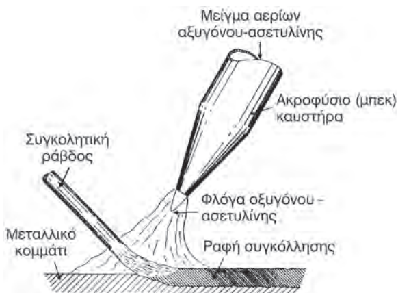
Σχήμα 8.3.1α: Η αρχή λειτουργίας της οξυγονοσυγκόλλησης
