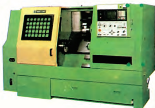
Σχήμα 1.3β Σύγχρονος προγραμματιζόμενος τóρνος (CNC) και η εργαλειοφόρα κεφαλή του
