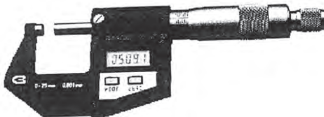
Σχήμα 3.2.5στ Ηλεκτρονικό ψηφιακό μικρόμετρο
