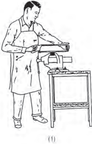
Σχήμα 4.9δ -1. Σωστή θέση κατά το πριόνισμα -2. Σωστό κράτημα του πριονιού
