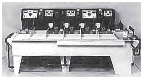
Σχήμα 12.3α Επιμετάλλωση με ηλεκτρόλυση: -1. Φορητή Μονάδα για επιτόπια επισκευή, -2. Συμπαγής Μονάδα για μικροαντικείμενα
