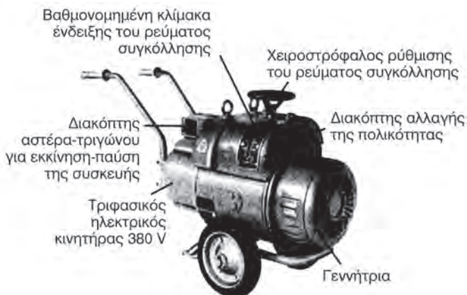
Σχήμα 8.4.5α: Μηχανή ηλεκτροσυγκόλλησης τόξου συνεχούς ρεύματος με γεννήτρια.
