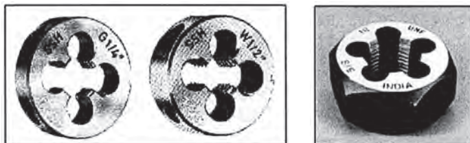
Σχήμα 4.16ε Ολόσωμοι βιδολόγοι
