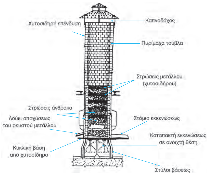
Σχήμα 10.2.1γ Κάμιнос ανάτηξης ή κάμιнос κουπόλα
