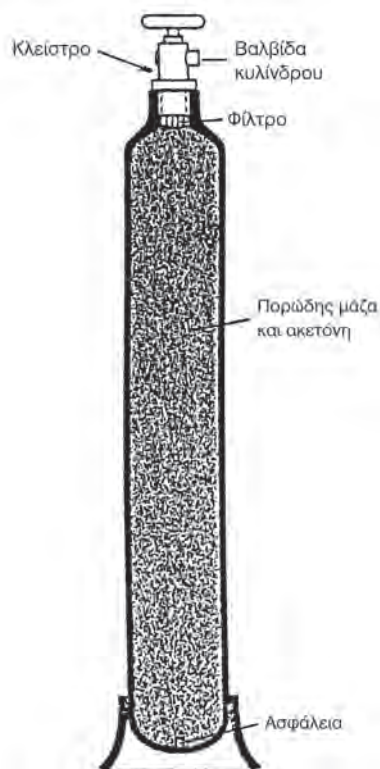
Σχήμα 8.3.3α: Φιάλη ασετυλίνης
