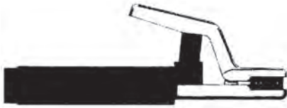
Σχήμα 8.4.2α: Λαβίδα συγκρατήσεως του ηλεκτροδίου (αρνητικός πόλος)
