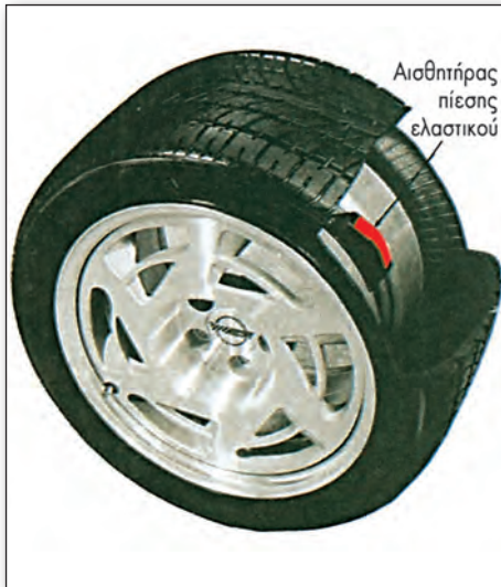
Σχ.5.55 Ελαστικό με αισθητήρα πίεσης επάνω στη ζάντα και μέσα στο ελαστικό. Έτσι, όταν η πίεση του ελαστικού γίνει μικρότερη από 25psi (172KPa), στέλνει σήμα στο ταμπλό των οργάνων και ανάβει μια λυχνία, που δηλώνει ότι η πίεση του ελαστικού είναι χαμηλή.
