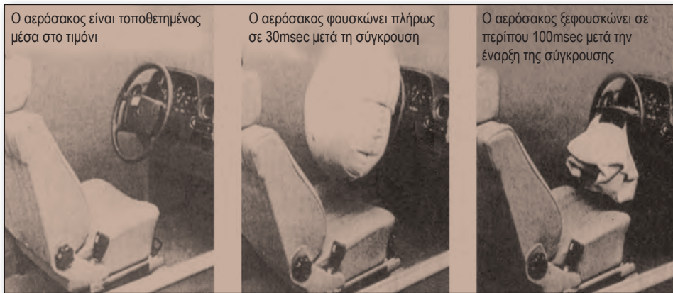
Σχ.9.7 Αερόσακος προστασίας από μετωπική σύγκρουση.
