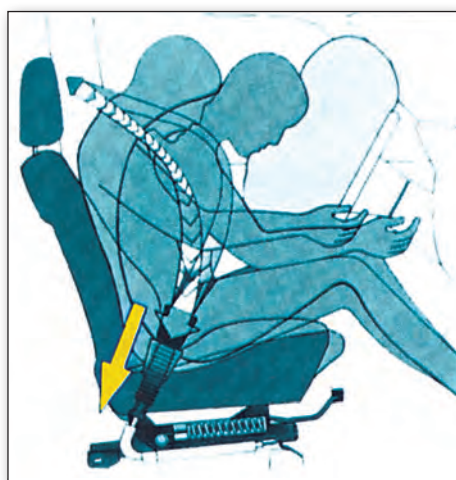
Σχ.9.6 Ζώνη ασφαλείας με σύστημα προεντατήρα και αερόσακο.
