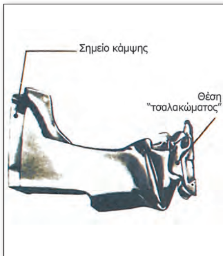
Σχ.1.44 Ζώνη απορρόφησης ενέργειας (τμήμα επιμήκους δοκού αμαξώματος).
