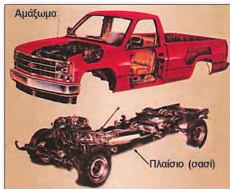
Σχ.1.25 Μικρό φορτηγό, που έχει ανεξάρτητο αμάξωμα και πλαίσιο. (Το αμάξωμα φαίνεται επάνω από το σασί - πλαίσιο κάτω).
