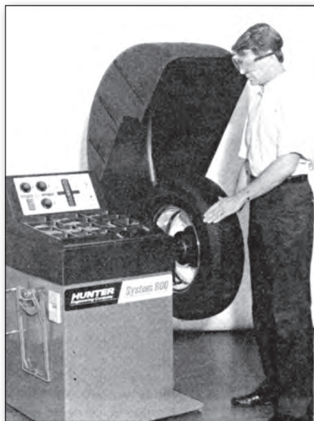
Σχ.5.63 Σύγχρονο μηχάνημα ζυγοστάθμισης, το οποίο δείχνει πού και πόσο βάρος είναι αναγκαίο να προστεθεί, για να διορθωθεί η ζυγοστάθμιση του τροχού.
