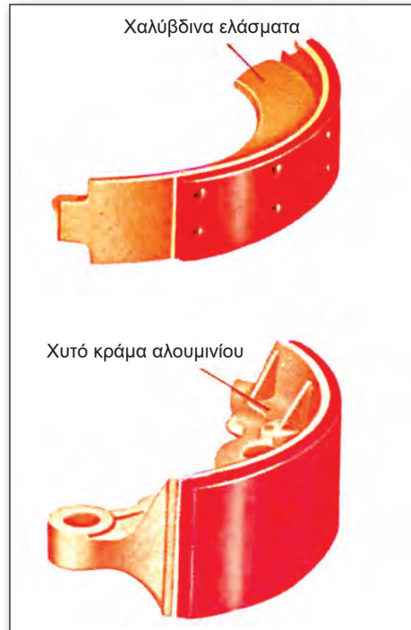
Σχ.6.11 Σιαγόνες (α) Από συγκολλημένα φύλλα ελατού χάλυβα με περτσίνωμα του υλικού τριβής (θερμουίτ) (β) Από χυτό χάλυβα ή χυτό κράμα αλουμινίου με συγκόλληση του υλικού τριβής (θερμουίτ)
