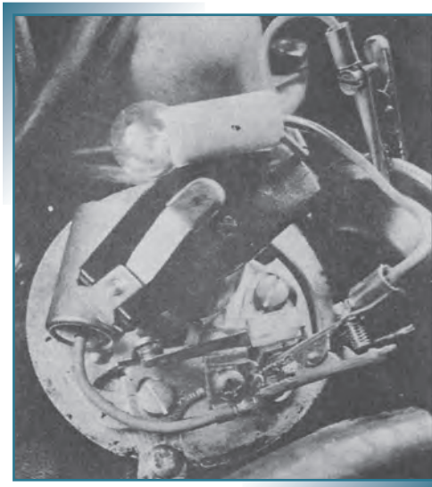
Σχήμα 23.2: Συνδεσμολογία δοκιμαστικού λαμπτήρα, παράλληλα με τις πλατίνες.
