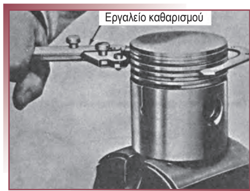
Σχήμα 10.3: Εργαλείο καθαρισμού των αυλακιών του εμβόλου.
