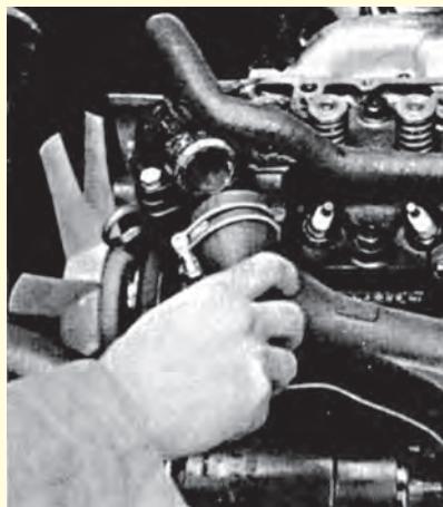
Σχήμα 8.2: Αφαίρεση των ελαστικών σωλήνων του ψυγείου από την κυλινδροκεφαλή
