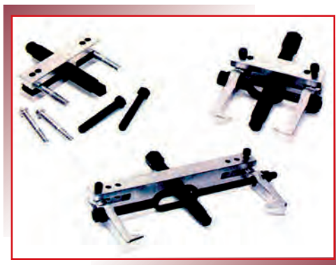
Σχήμα 2.2 Ειδικά εργαλεία - Εξολκείς
