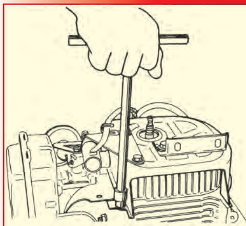
Σχήμα 44.22 Αφαίρεση των βιδών που συγκρατούν το επάνω κάλυμμα του κυλίνδρου της μηχανής.
