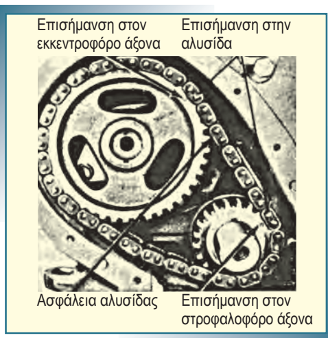
Σχήμα 19.7: Τέσσερα σημάδια χρονισμού (2+2), σε αλυσοτροχούς χρονισμού.
