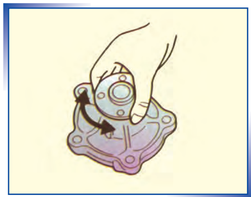
Σχήμα 33.3 Έλεγχος της αντλίας νερού.
