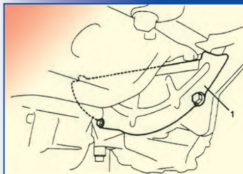
Σχήμα 25.10 Επανατοποθέτηση της κάτω πλάκας (1) του κελύφους του συμπλέκτη.
