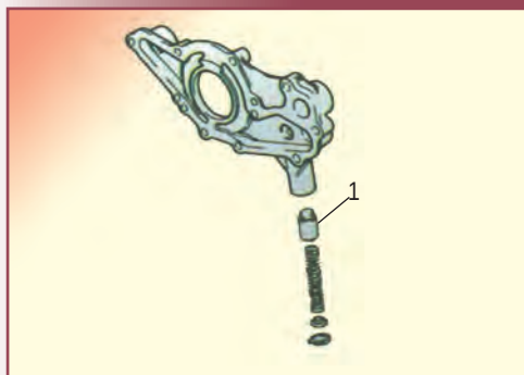
Σχήμα 26.8 Έλεγχος της βαλβίδας ανακούφισης.
