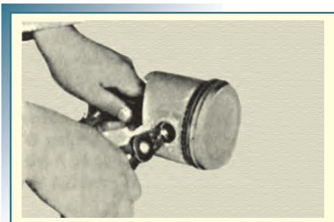
Σχήμα 11.7: Αφαίρεση ασφαλιστικών παράκλων (circlips) με μυτοσίμπιδο ανοικτού τύπου.
