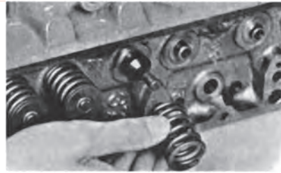
Σχήμα 16.10: Αφαίρεση του ελατηρίου της βαλβίδας.
