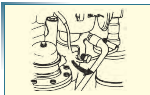
Σχήμα 23.6: Αποσύσφιξη του κοχλία συγκράτησης του διανομέα.
