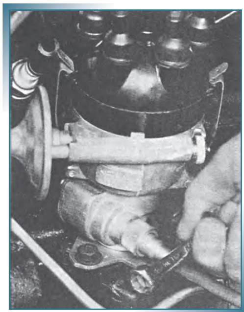
Σχήμα 23.8: Σύσφιγξη του κοχλία συγκράτησης του διανομέα και σταθεροποίησή του στη θέση αυτή.
