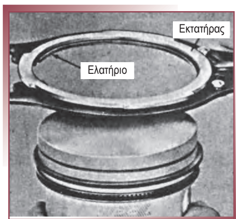
Σχήμα 10.2: Εργαλείο αφαίρεσης και επανατοποθέτησης ελατηρίων στο έμβολο ("εκτατήρας").
