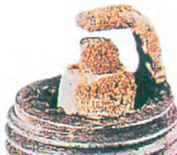
Λερωμένος αναφλεκτήρας από καύση λιπαντικού
