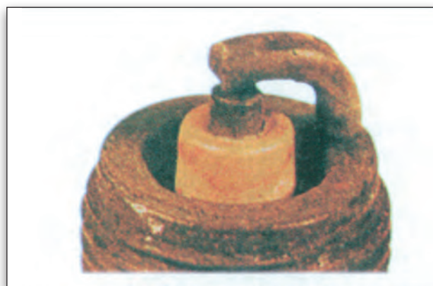
Σχήμα 11.25. Σπινθηριστής με κιτρινωπή πορσελάνη.
