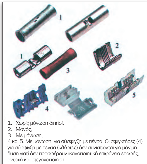
Σχήμα 3.33. Σφικτήρες αγωγών.
