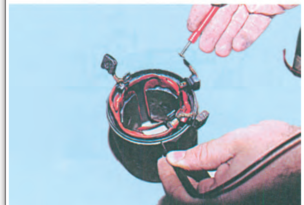
Σχήμα 10.48. Διαδικασία ελέγχου πηνίων διέγερσης.
