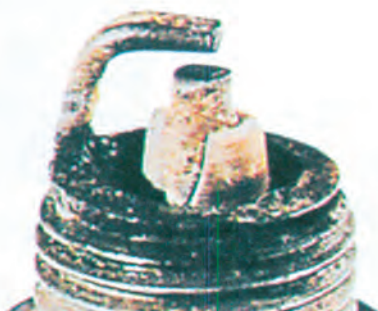
Κατεστραμμένη μόνωση κεντρικού ηλεκτροδίου
