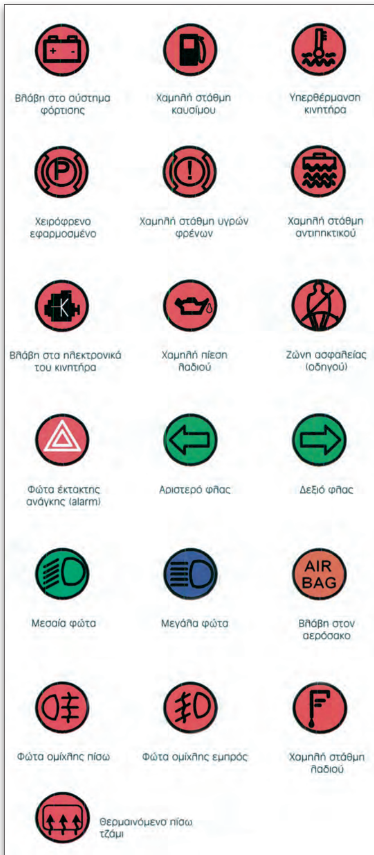
Σχήμα 5.20. Σύμβολα ενδεικτικών και προειδοποιητικών λυχνιών πίνακα οργάνων.
