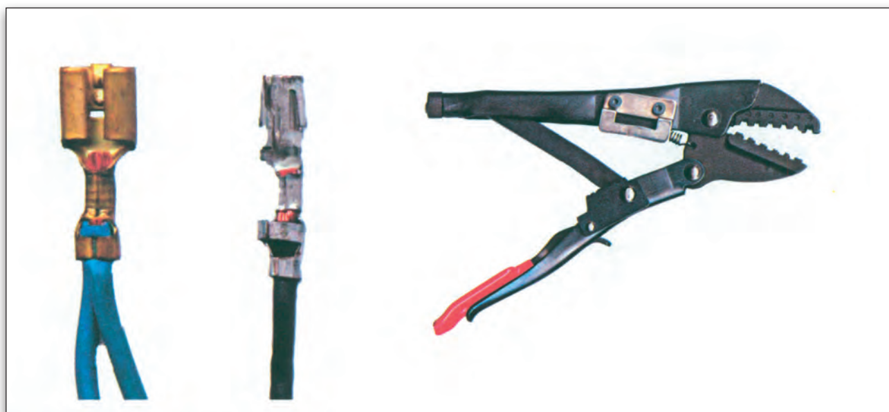
Σχήμα 3.25. Ένωση ακροδέκτη με σύσφιγξη, ειδικό εργαλείο.
