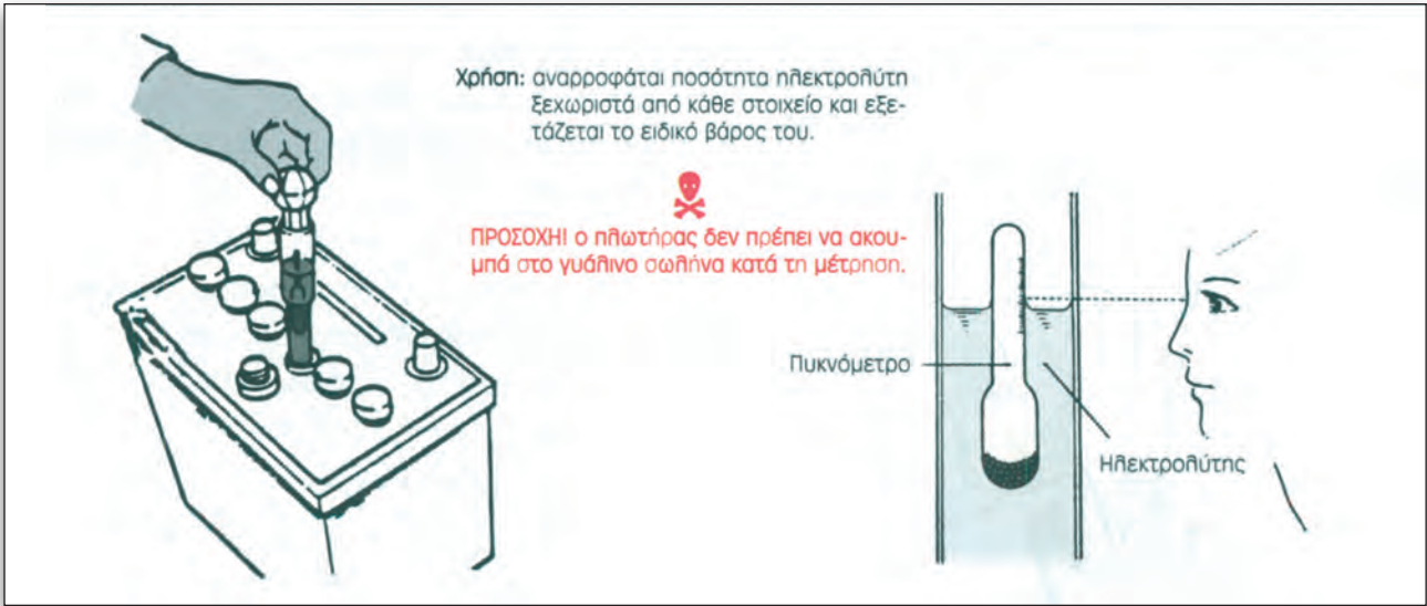
Σχήμα 9.19. Έλεγχος φόρτισης συσσωρευτή με πυκνόμετρο.
