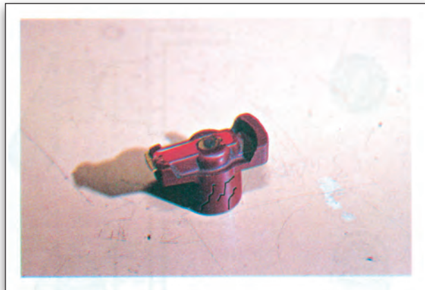
Σχήμα 11.61. Έλεγχος φθοράς στο ράουηλο.
