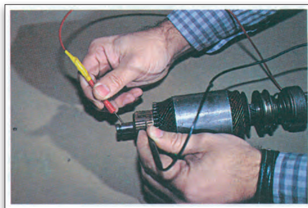
Σχήμα 10.51. Έλεγχος του συλλέκτη για διαρροή με τον άξονα.
