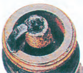
Κατεστραμμένο ηλεκτρόδιο γείωσης
