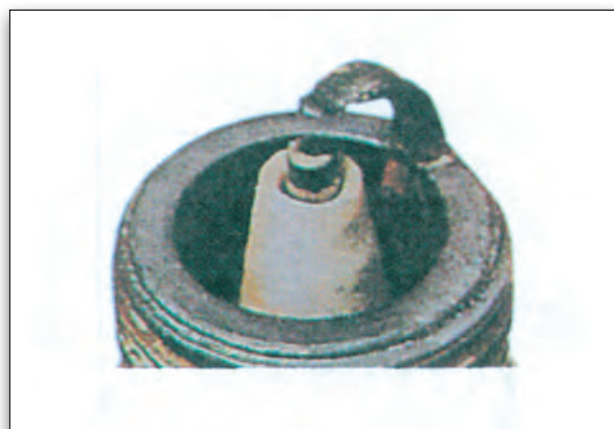
Σχήμα 11.26. Σπινθηριστής με άσπρη πορσελάνη.
