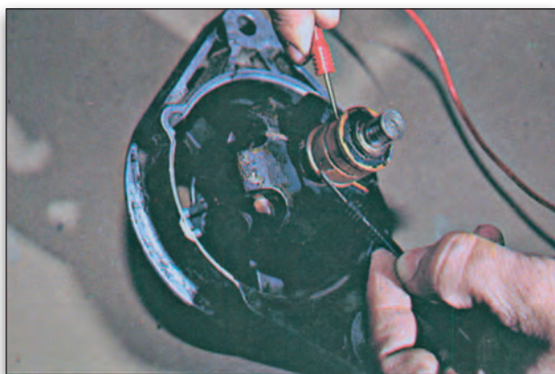
Σχήμα 8.41. Έλεγχος τυλίγματος δρομέα.
