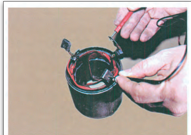
Σχήμα 10.46. Έλεγχος βάθους και διαμόρφωση άκρων συλθέκτη.
