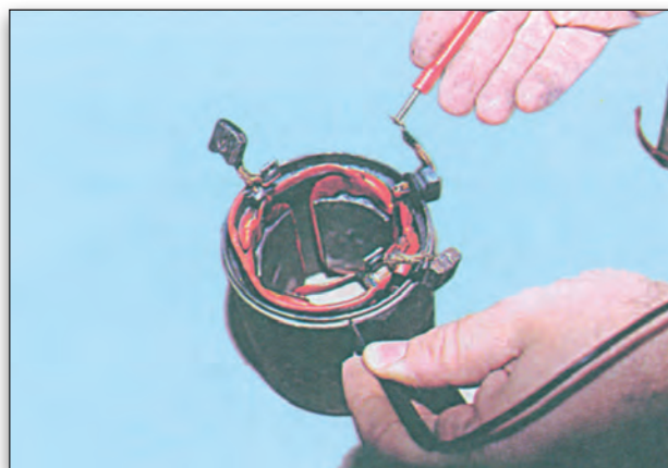
Σχήμα 8.26. Έλεγχος μόνωσης του τυλίγματος διέγερσης ως προς το σώμα.
