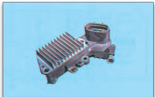
Σχήμα 8.12. Αυτόματος ρυθμιστής ηλεκτρονικού τύπου IC.
