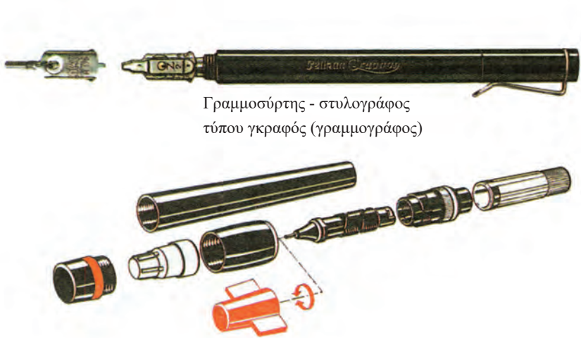
Σχήμα 2.5 Γραμμοσύρτης - στυλογράφος τύπου γκραφός (γραμμογράφος)
