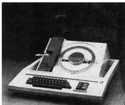
Σχήμα 4.6 Μηχανή που γράφει γράμματα σε οδηγητική ταινία
