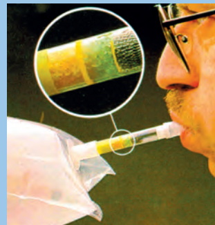
ΣΧΗΜΑ 3.4 Αν ο αέρας της εκπνοής περιέχει αιθανόλη, τότε αλλάζει το χρώμα του γυάλινου σωλήνα που περιέχει οξεινισμένο \text{K}_2\text{Cr}_2\text{O}_7 .
