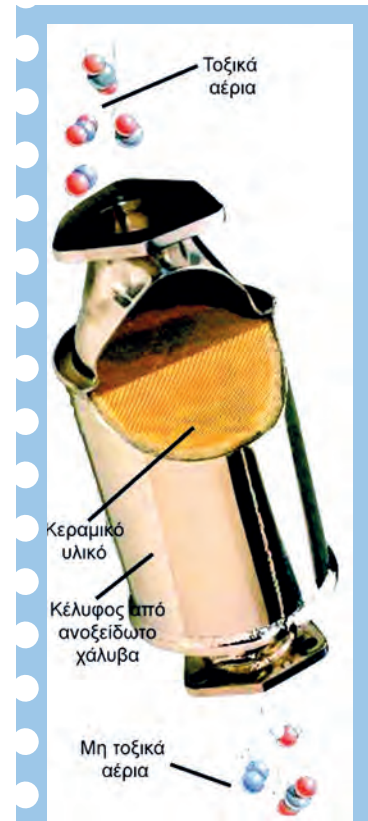
ΣΧΗΜΑ 2.8 Κατασκευαστικές λεπτομέρειες καταλυτικού μετατροπέα. Το κέλυφος είναι από ανοξείδωτο χάλυβα. Ο καταλύτης συνήθως αποτελείται από λευκόχρυσο (Pt) και ρόδιο (Rh) πάνω σε υπόστρωμα από κεραμικό υλικό με ενδιάμεση επίστρωση αλουμίνιας (Al 2 O 3 ).
