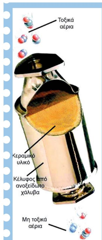
ΣΧΗΜΑ 2.8 Κατασκευαστικές λεπτομέρειες καταλυτικού μετατροπέα. Το κέλυφος είναι από ανοξείδωτο χάλυβα. Ο καταλύτης συνήθως αποτελείται από λευκόχρυσο (Pt) και ρόδιο (Rh) πάνω σε υπόστρωμα από κεραμικό υλικό με ενδιάμεση επίστρωση αλουμίνιας (Al<sub>2</sub>O<sub>3</sub>).
