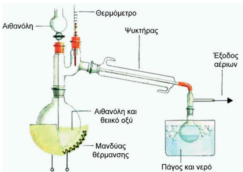
ΣΧΗΜΑ 3.5 Εργαστηριακή διάταξη για την παρασκευή  $C_2H_5OC_2H_5$  με αφυδάτωση  $C_2H_5OH$ .
