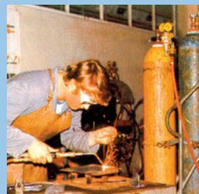
Η φλόγα από την καύση του ακετυλενίου έχει πολύ υψηλή θερμοκρασία και γι' αυτό χρησιμοποιείται για την κοπή και συγκόλληση των πολύ δύσστηκτων μετάλλων.
