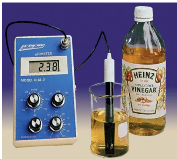
ΣΧΗΜΑ 3.5 Ο προσδιορισμός του pH με πεχάμετρο μπορεί να γίνει με μεγάλη ακρίβεια.
