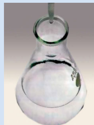
Με προσθήκη οξέος σε διάλυμα βάσης η φαινολοφθαλείνη, που βρίσκεται στο διάλυμα, αποχρωματίζεται.
