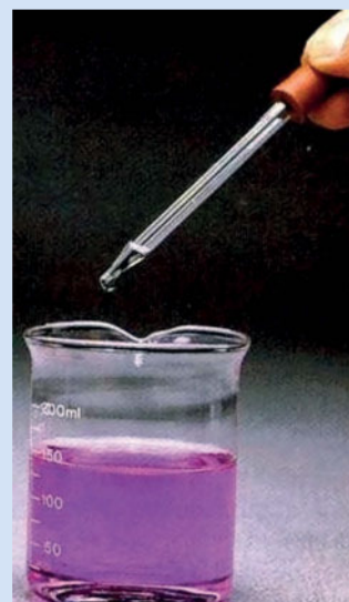
Με προσθήκη βάσης σε διάλυμα οξέος η φαινολοφθαλεΐνη που βρίσκεται στο διάλυμα χρωματίζεται κόκκινη.
