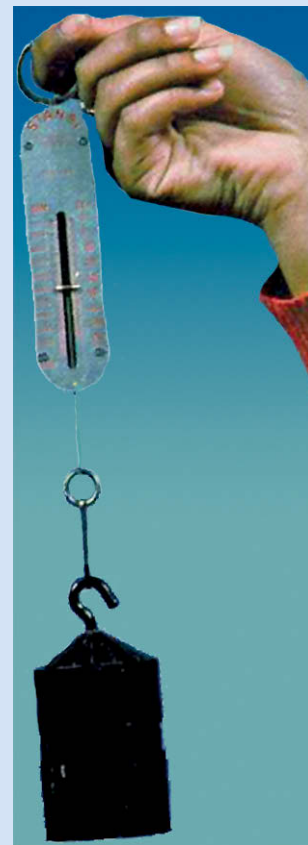
Το δυναμόμετρο είναι όργανο μέτρησης βάρους.
