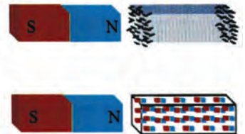
Μαγνήτιση με επαγωγή. Εικόνα 4.1-16.
