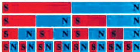
Εικόνα 4.1-10. Κόβοντας το μαγνητισμένο έλασμα παίρνουμε συνέχεια νέους μαγνήτες.
