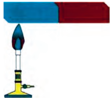
Απομαγνήτιση υλικού με θέρμανση.
