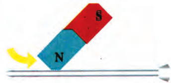
Αν και τρίβουμε μόνο το βόρειο πόλο το καρφί αποκτά βόρειο και νότιο πόλο. Εικόνα 4.1-17.
