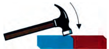
Απομαγνήτιση υλικού με κρούση.
