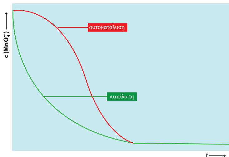
ΣΧΗΜΑ 3.6 Η καμπύλη της αντίδρασης στην κατάλυση και στην αυτοκατάλυση, με βάση την αντίδραση οξειδωσης του οξαλικού οξέος με υπερμαγγανικό κάλιο.
