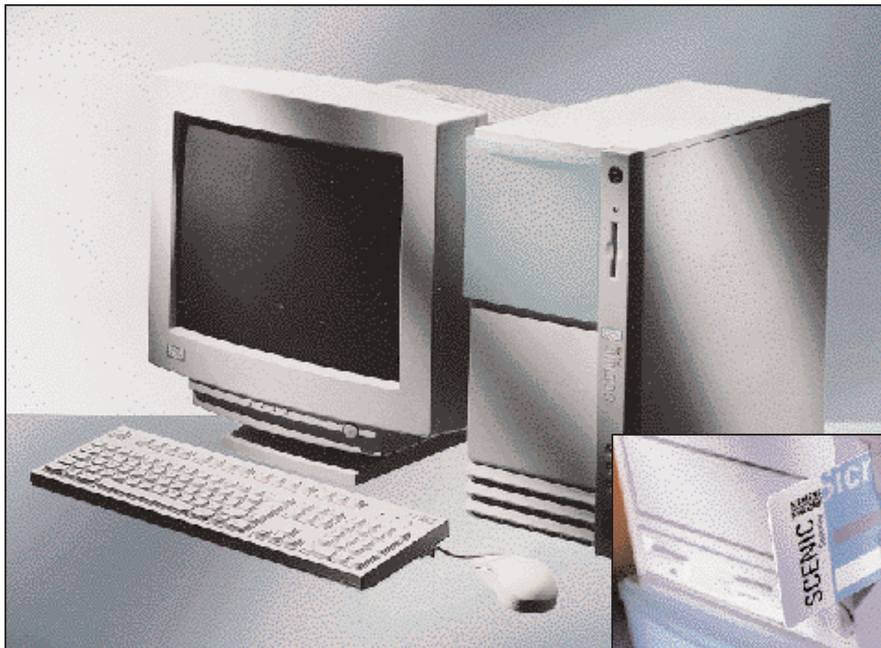
Οι προσωπικοί υπολογιστές αρκετών κατασκευαστών διαθέτουν ήδη (όπως ο εικονιζόμενος της Siemens Nixdorf) ειδικό αναγνώστη (πιστωτικών ή «έξυπνων») καρτών, που είτε ελέγχει την πρόσβαση στο ίδιο το μηχάνημα είτε επιτρέπει τη διεξαγωγή ηλεκτρονικών τραπεζικών εργασιών και ηλεκτρονικού εμπορίου. (Πηγή: SNI)
