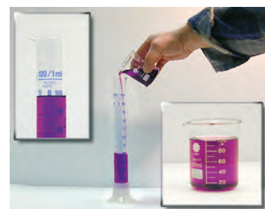
Ο όγκος του υγρού πριν και μετά τη μετάγγιση παραμένει 100 mL, όμως το σχήμα του υγρού άλλαξε.
