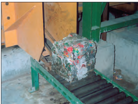
Εικ. 7.9 Διαχωρισμός αλουμινίου σε εργοστάσιο μηχανικής διαλογής
