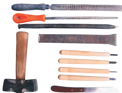
218. Εργαλεία λάξευσης: λίμες, βάλονι, χτένι, μαχαίρια, κοπίδι, γούτζες, σκαρπέλο, βαριά.
