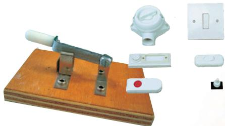
Οι διακόπτες είναι απαραίτητο στοιχείο κάθε ηλεκτρικού κυκλώματος. Τους παρατηρούμε παντού γύρω μας, σε όλες τις ηλεκτρικές συσκευές και σε κάθε ηλεκτρικό κύκλωμα. Με τη χρήση του διακόπτη μπορούμε εύκολα να ανοίγουμε και να κλείνουμε το ηλεκτρικό κύκλωμα, να διακόπτουμε δηλαδή για όσο διάστημα επιθυμούμε τη ροή των ελεύθερων ηλεκτρονίων.
