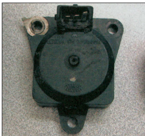
Σχήμα 19: Αισθητήρας απόλυτης πίεσης (υποπίεσης) του εισερχομένου αέρα στην πολλαπλή εισαγωγή.
