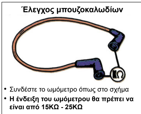
Σχήμα 10: Έλεγχος μπουζοκαλωδίων με ωμόμετρο.
