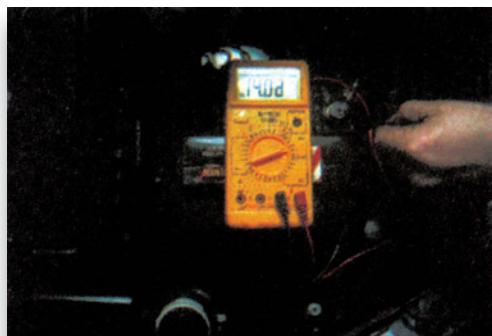
Σχήμα 2: Έλεγχος της τάσης φόρτισης του εναλλακτήρα με πολύμετρο.
