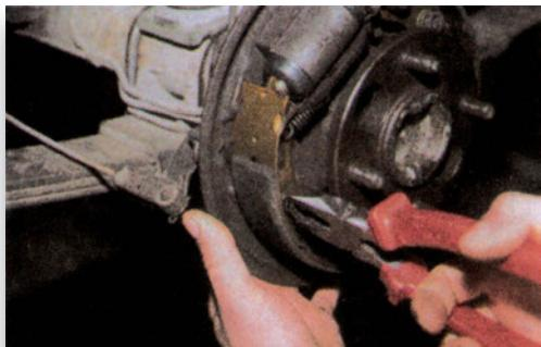
**Σχήμα 4:** Αφαίρεση ελατήριου του πείρου στερέωσης.
