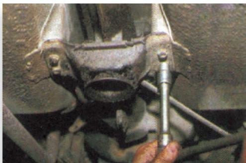
**Σχήμα 7:** Αφαίρεση ελαστικής βάσης.
