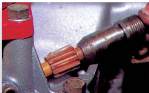
**Σχήμα 19:** Αφαίρεση του γραναζιού του χιλιομετρητή.
