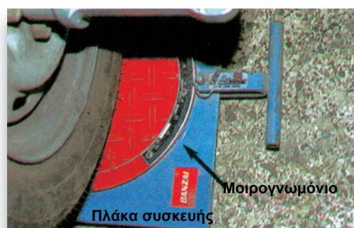
**Σχήμα 2:** Πλάκα και μοιρογνωμόνιο ευθυγράμμισης.
