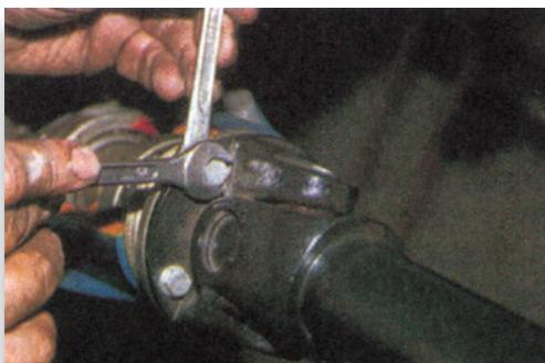
**Σχήμα 5:** Αποσύνδεση του κεντρικού άξονα.
