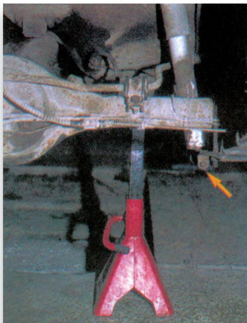
Σχήμα 2: Στήριξη του άξονα και αφαίρεση του αμορτισέρ.
