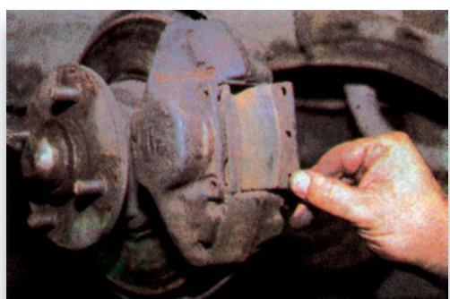
**Σχήμα 9:** Αφαίρεση τακακίων.
