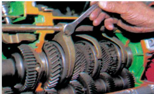
**Σχήμα 16:** Αφαίρεση των κοχλιών συγκράτησης των διχάλων.
