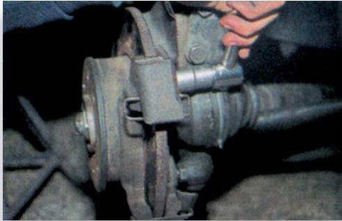
**Σχήμα 12:** Αφαίρεση του στηρίγματος του δισκόφρενου.
