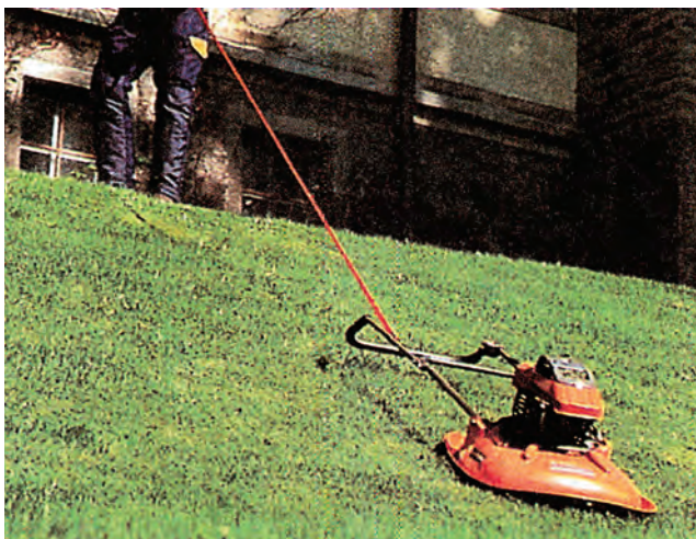
Εικ. 2.7 Χλοοκοπτικό μηχάνημα με μεσινέζα, που χρησιμοποιείται σε χλοοτάπητες με μεγάλη κλίση.
