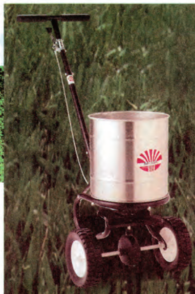
Εικ. 2.15 - 2.16 Λίπανση σε μικρές επιφάνειες χλοοτάπητα, με τροχήλατο μηχάνημα (Λιπασματοδιανομέας)
