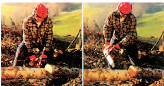
Εικ. 16.43 Ασφαλής χρήση αλυσοπρίονου, σε εφαρμογή κοπής κορμού δένδρου (διαδοχικά στάδια)
