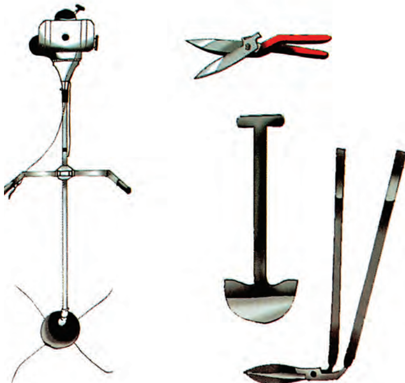
Εικ. 2.13 Εργαλεία που χρησιμοποιούνται για την κοπή της άκρης του χλοοτάπητα.
