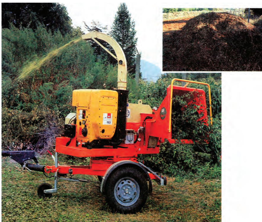
Εικ. 10.6 Μετατροπή των κλαδιών σε «wood chip» από κλαδοφάγο
