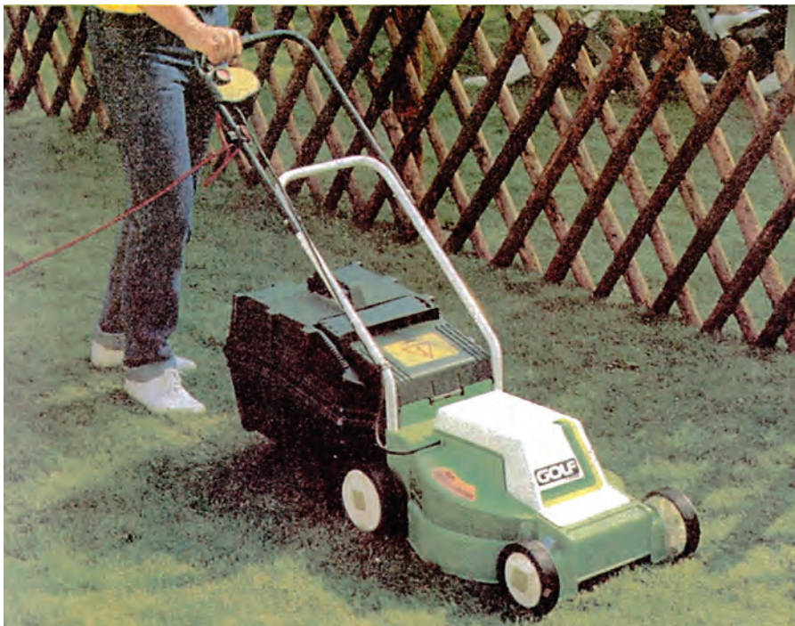
Εικ. 2.5 Χλοοκοπτικό περιστροφικού τύπου (ηλεκτροκίνητο)
