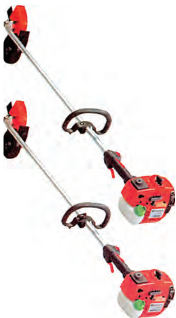
Εικ. 2.11 Μηχάνημα κοπής της άκρης του χλοοτάπητα, που φέρει δίσκο κάθετης κοπής.
