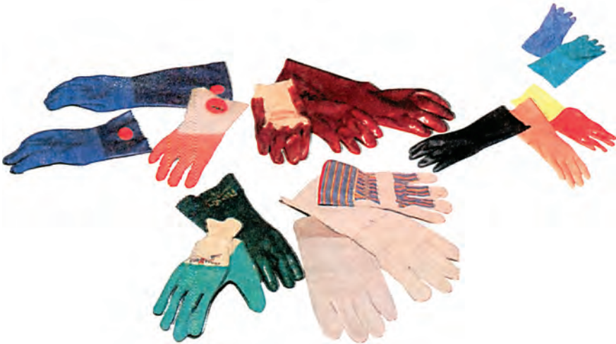
Εικ. 16.10 Γάντια από δέρμα, ύφασμα, ελαστικό, νιτρίλιο, PVC για αποτελεσματική προστασία των χεριών από κοψίματα, χημικά κάθε είδους, υψηλές και χαμηλές θερμοκρασίες, ακτινοβολίες, ηλεκτρολογικές εργασίες κ.λπ.
