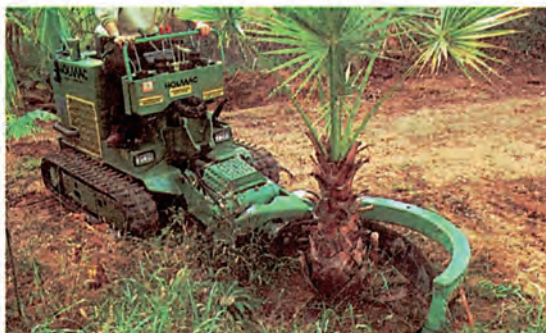
5. Εξαγωγή φοίνικα από το έδαφος με ερπυστριοφόρο μεταφυτευτικό μηχανήμα με ημικυκλικό μαχαίρι
