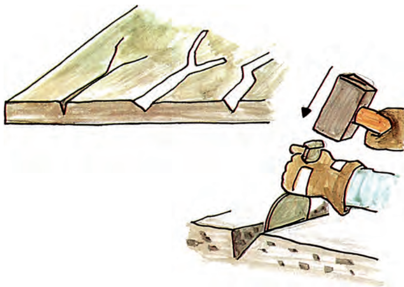
Εικ. 14.1 Αποκατάσταση ρωγμών σε διάδρομο από μπετόν
