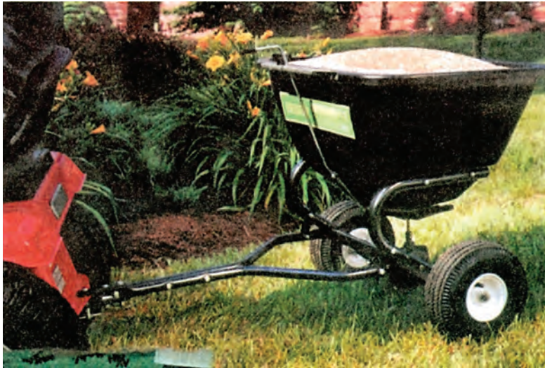
Εικ. 2.18 Λίπανση χλοοτάπητα, με ελκόμενο από μικρό τρακτέρ τροχήλατο λιπασματοδιανομέα
