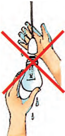
Εικ. 16.24 Δεν πρέπει να χρησιμοποιούνται βρεγμένα χέρια στο χειρισμό ηλεκτρικών λαμπτήρων.
