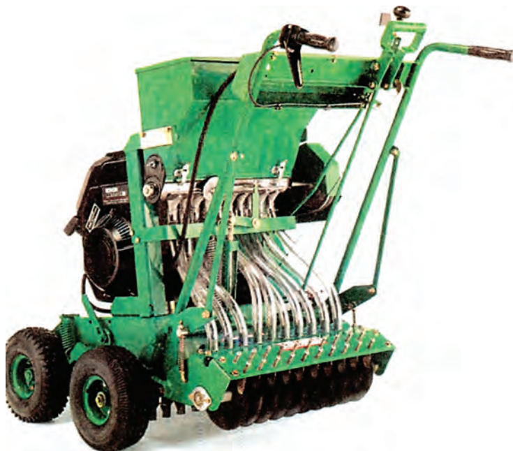
Εικ. 2.32 Ολοκληρωμένο μηχάνημα συντήρησης χλοοτάπητα, που συγχρόνως αερίζει, σπέρνει, λιπαίνει και καλύπτει τον ταλαιπωρημένο χλοοτάπητα.
