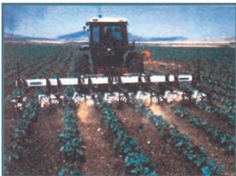
Εικ. 4.14 Φρεζοσκαλιστήρι έξι σκαλιστικών στελεχών, σε γραμμική καλλιέργεια.
