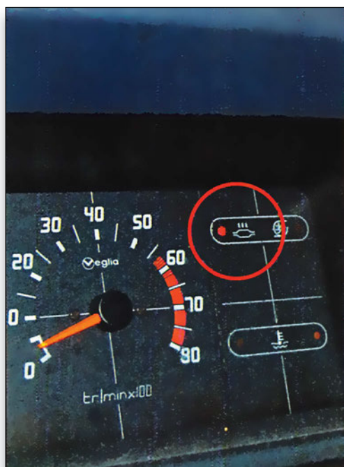
Σχήμα 8.5: Προειδοποιητική λυχνία για καταγραφή βλάβης (CHECK ENGINE).
