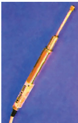
Σχήμα 6.32: Ηλεκτρομηχανικοί αισθητήρες γραμμικής μετατόπισης.
