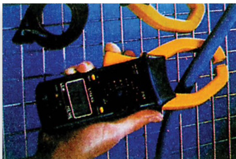
Σχήμα 2.13: Αμπερόμετρο με επαγωγική τσιμπίδα μέτρησης.
