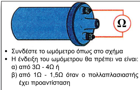
Σχήμα 9.30: Έλεγχος πρωτεύοντος πηνίου πολλαπλασιαστή.
