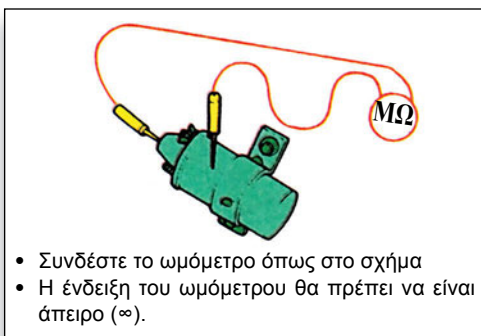
Σχήμα 9.32: Έλεγχος βραχυκυκλώματος πολλαπλασιαστή.
