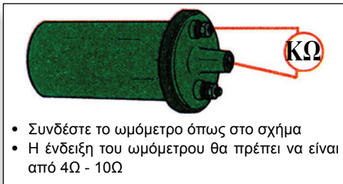
Σχήμα 9.31: Έλεγχος δευτερεύοντος πηνίου πολλαπλασιαστή.
