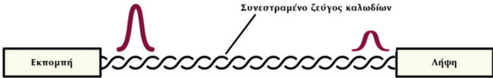
Εικόνα 2.4.1.θ: Εξασθένιση (Attenuation, Insertion Loss).
