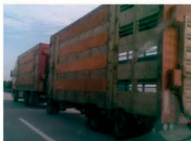
Συρόμενο μεταφοράς ζώων
