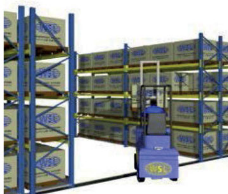
Εικόνες 9.15 και 9.16: Παραδείγματα κινητών ραφιών
