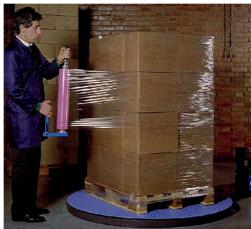
Εικόνες 8.4 και 8.5: Stretch film και τσέρκι
