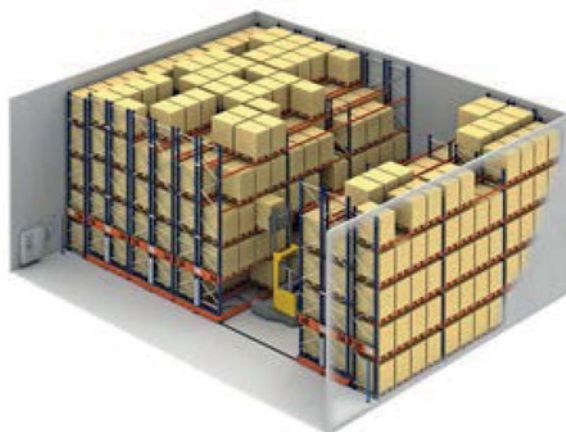
Εικόνα 9.14: Λειτουργία κινητών ραφιών
