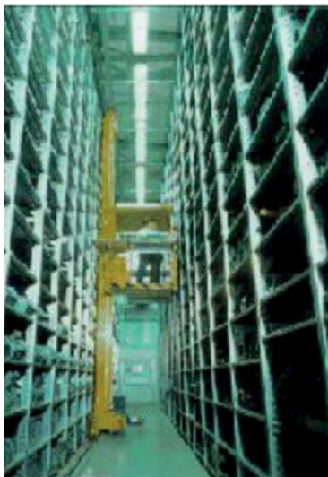
Εικόνα 9.13: Υψηλά ράφια παλέτας μεγάλου ύψους και πολύ στενών διαδρόμων
